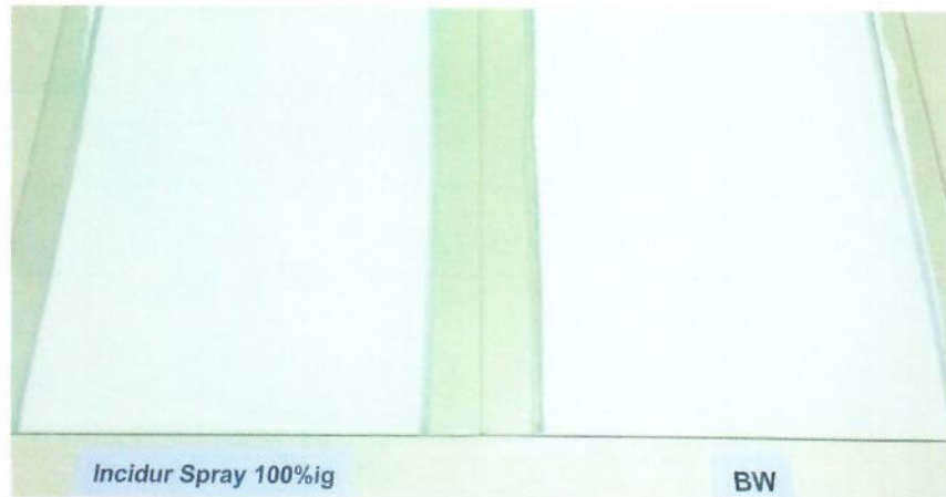
Abb. 3: Aussehen des Probekörpers nach 10 Beanspruchungen mit 100%iger Incidur-Lösung im Vergleich zum unbeanspruchten Probenkörper (Blindwert BW)
